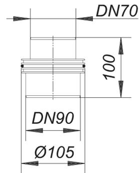
para conectar el dispositivo antivació 900 a tuberías de agua residual DN 70 y DN 90
