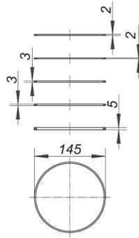
adecuado para las rejillas de diseño con d: 145 mm
