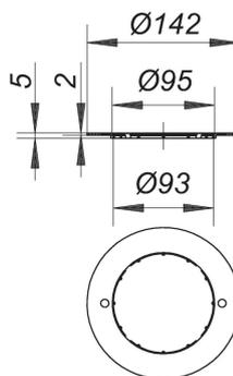
recambio para los elementos de elevación CeraDrain/TistoDrain S 10.
