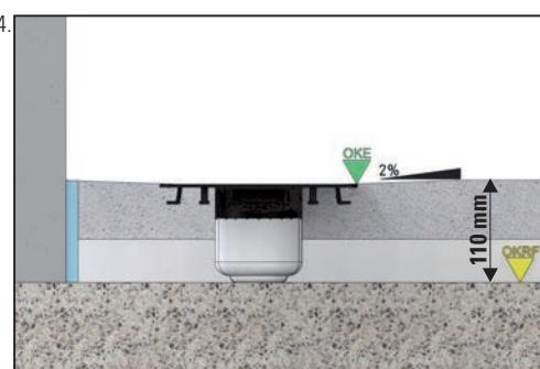
DE Anker entfernbar (z.B. zum Einbau in Holzbalkendecken)
