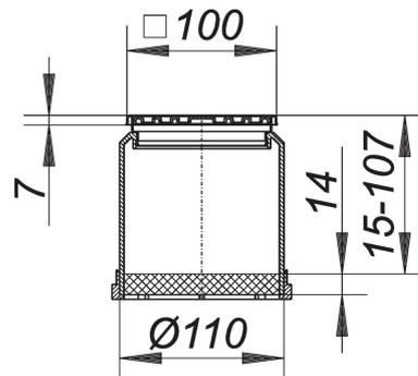
passend zu den Ablaufgehäusen 40, 42, 46, den Balkonablaufgehäusen und Entwässerungselementen für Attikaabläufe, sowie zu den Aufstockelementen 85.
