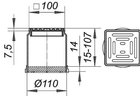
passend zu den Ablaufgehäusen 40, 42 und 46, den Balkonabläufen 83 und 84 sowie zu den Aufstockelementen 85
