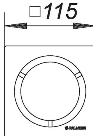
passend zu den Aufsatzrahmen mit Rahmenmaß 120-x-120-mm und Bodenabläufen TistoPrimus, Design-Rost mit Ablauföffnungen im Design Saturn, Oberfläche matt satiniert
