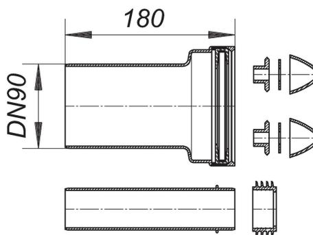
Ablaufstutzen 180 mm lang, mit innen liegender, doppelter Lippendichtung
